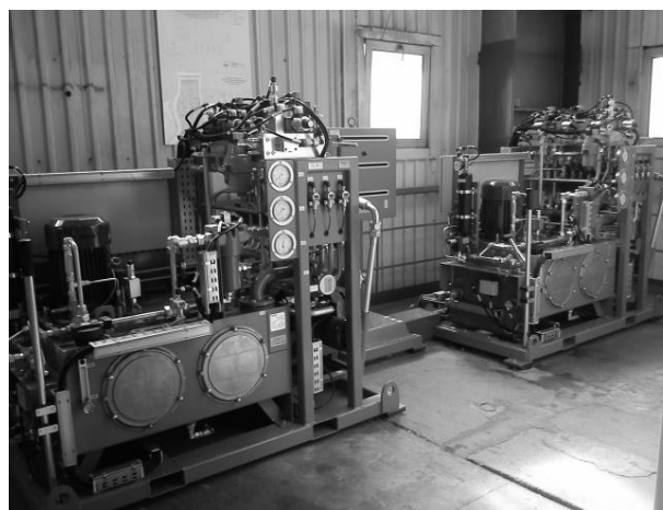
Rys. 3. Elektrohydrauliczny zespół zasilająco-sterujący hamulca H-C MWM-4/VER.III z przetłacznicą LP-4 [źródło: własne]
